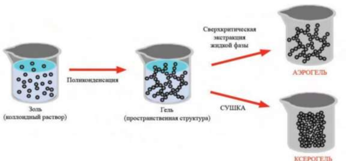
Рисунок 8 – Схематичное представление золь-гель процесса [21]
