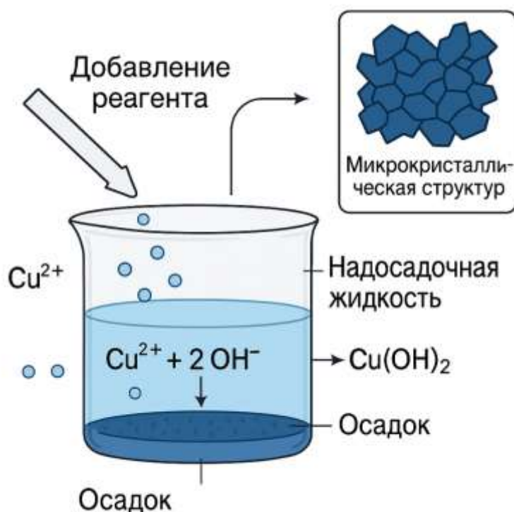
Рисунок 7 – Схема метода осаждения
